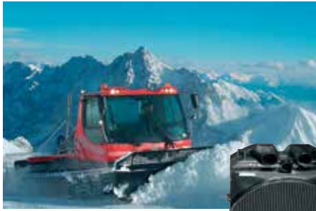
Комбинированный охладитель для охлаждающей жидкости и наддувочного воздуха для гусеничной машины для очистки трассы „PistenBully 600“ фирмы Kässbohrer
