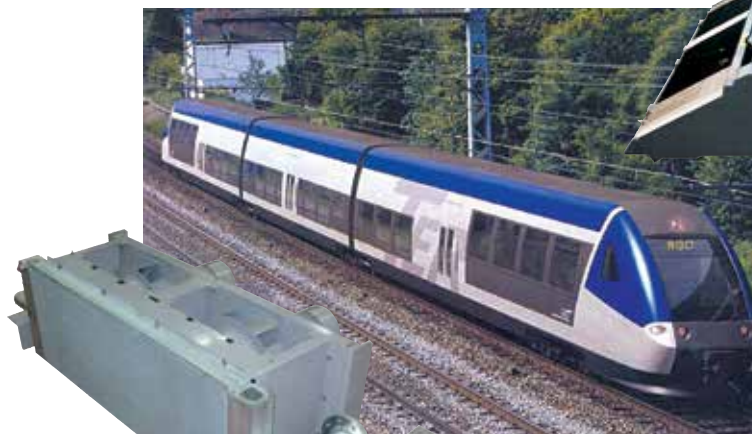
Подпольная охлаждающая установка для трансформаторного масла
