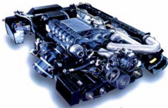
Комбинированный охладитель наддувочного воздуха и охлаждающей жидкости для железнодорожного транспортного средства „TALENT“ АО Немецких железных дорог
