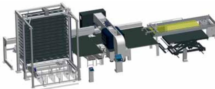
Автоматическая система погрузки – сортировки - штабелирования деталей:
