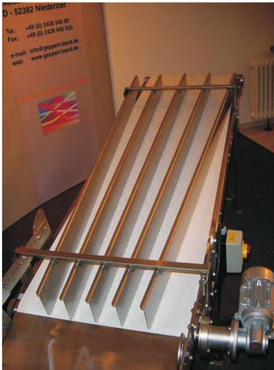
Am Ende des Förderbandes ist eine in Winkel und Position frei einstellbare Abgaberutsche angebracht.
