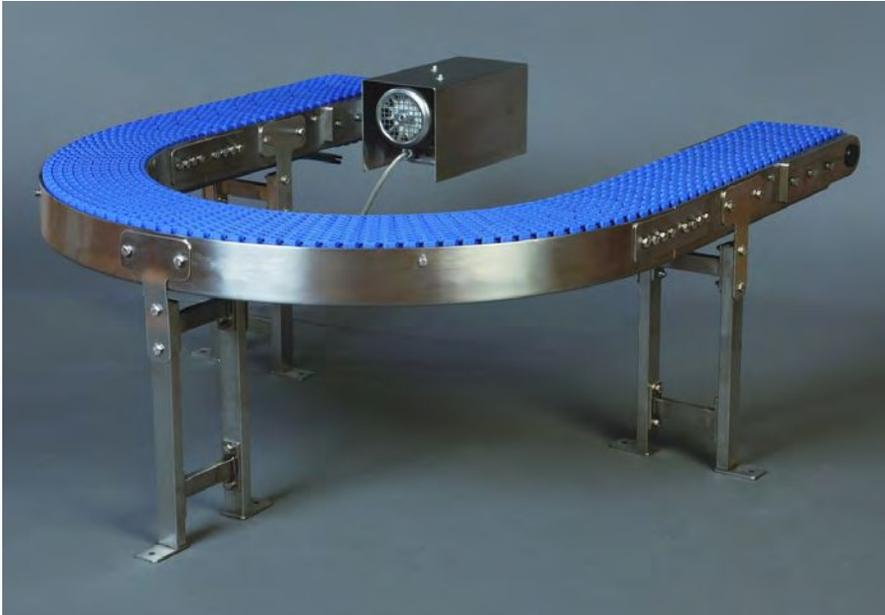
Das Kunststoffmodulband EM-C mit seinem Rahmen aus geschlossenen Edelstahl-Profilen ist besonders geeignet, um Fördergüter in hygienisch anspruchsvoller Umgebung durch Kurven zu fördern. Das EM-C kann dabei für jeden zu überbrückenden Winkel zwischen 15 und 180° passend hergestellt werden.
