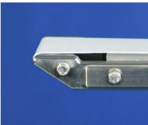
Mit dem Edelstahl-Messerkanten-Förderband GES-25-RMK wird der Transport von Kleinstteilen optimiert. Aufgrund des geringen Durchmessers der Umlenkrolle von nur 8 mm kann haarscharf übergeben oder übernommen werden. Die rollende Messerkante sorgt zusätzlich für eine sanfte Übergabe, denn das Stückgut wird lagerichtig weiter transportiert.
