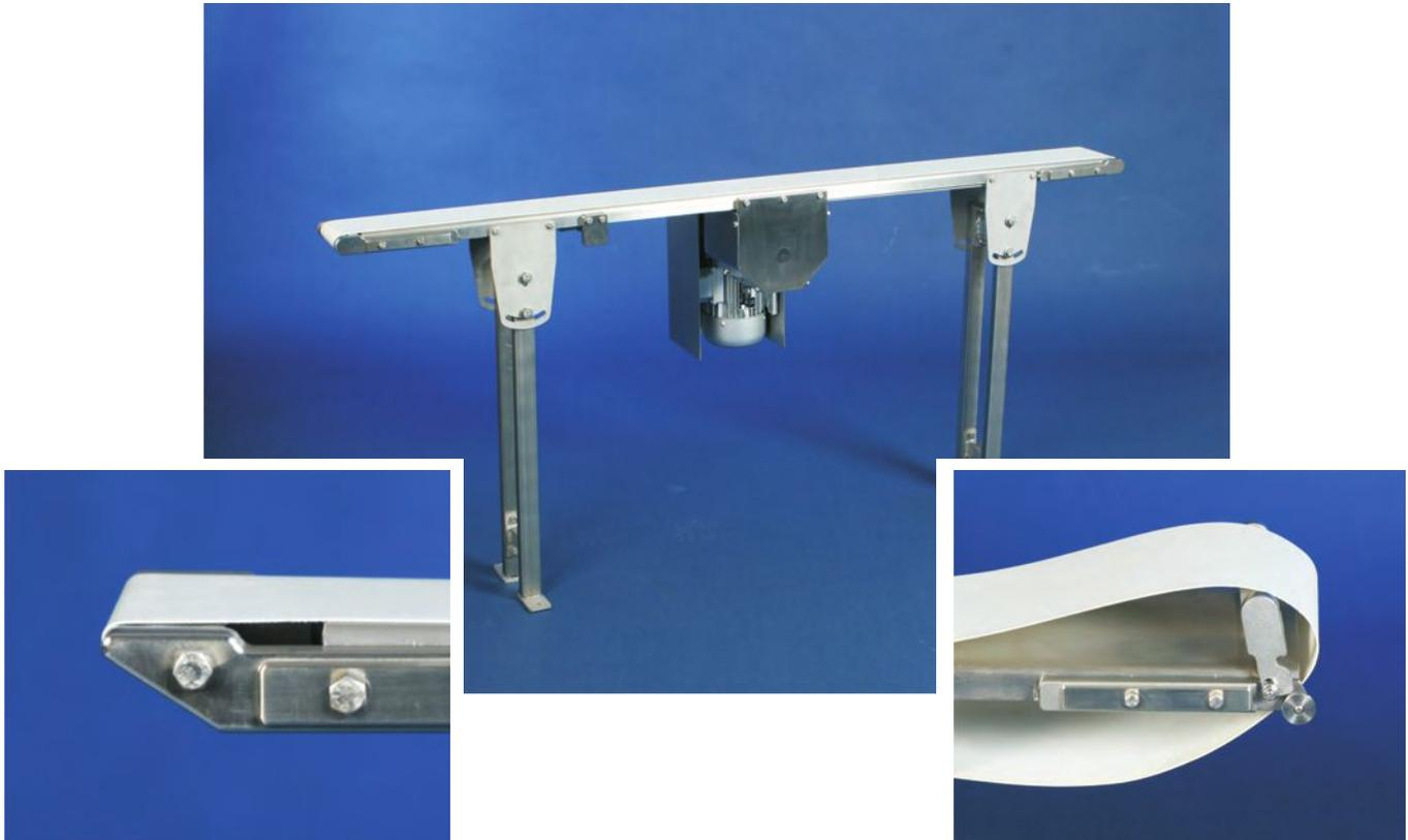
Mit dem Unterantrieb des GES-25-UA wird die Möglichkeit der Übergabe von Kleinteilen an beiden Enden des Förderbandes geschaffen. Da der Motor an jeder Stelle des Rahmens angebracht werden kann, lässt sich das Förderband an fast alle Platzverhältnisse in der Anwendung anpassen.
