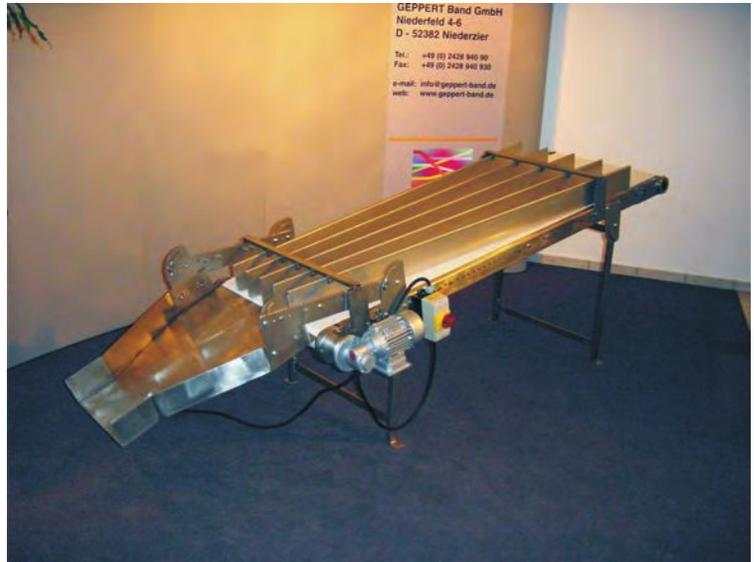
Das komplette Förderband wurde aus Edelstahl gefertigt und mit einem weißen Gurt mit FDA-Zulassung für Lebensmittelanwendungen ausgerüstet.
