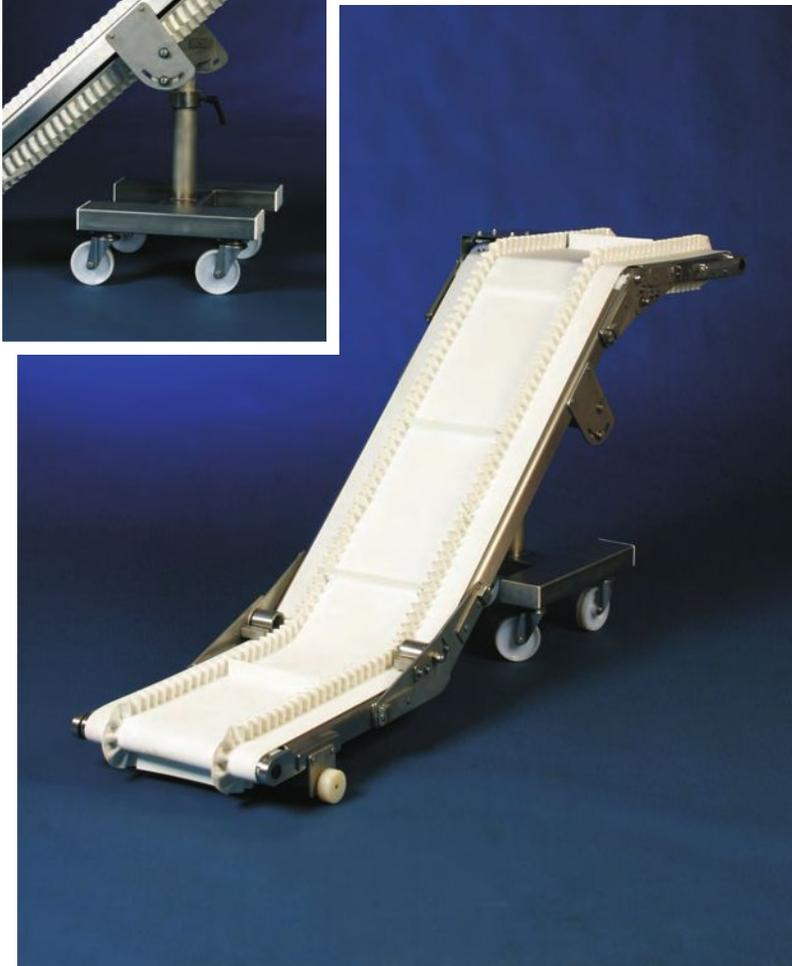
Das GES-50-Z-W hat einen Rahmen aus einem völlig geschlossenen Edelstahl-Profil. Dadurch erfüllt es allerhöchste hygienische Anforderungen. Die Spannvorrichtung an der Umlenk- und Antriebswalze ist in der patentierten CleanTec-Bauweise ausgeführt.
