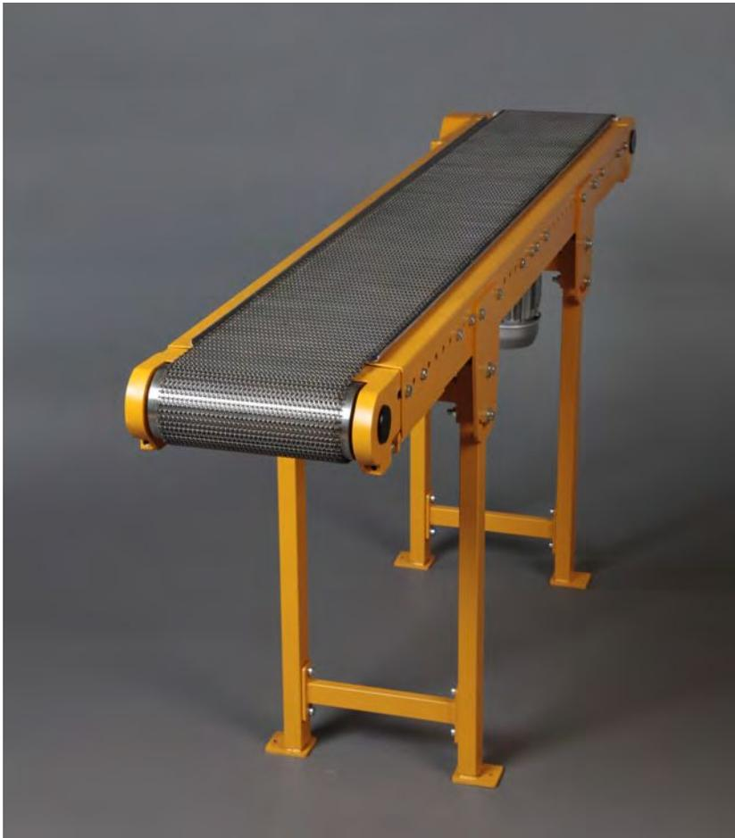
Das Flachförderband GF-80-RDG ist mit einem Runddraht-Gliedergurt ausgerüstet. Er eignet sich besonders für den Transport von sehr heißen Teilen. Durch seine mechanische Belastbarkeit ist er auch eine gute Alternative bei scharfkantigen Metallteilen.
