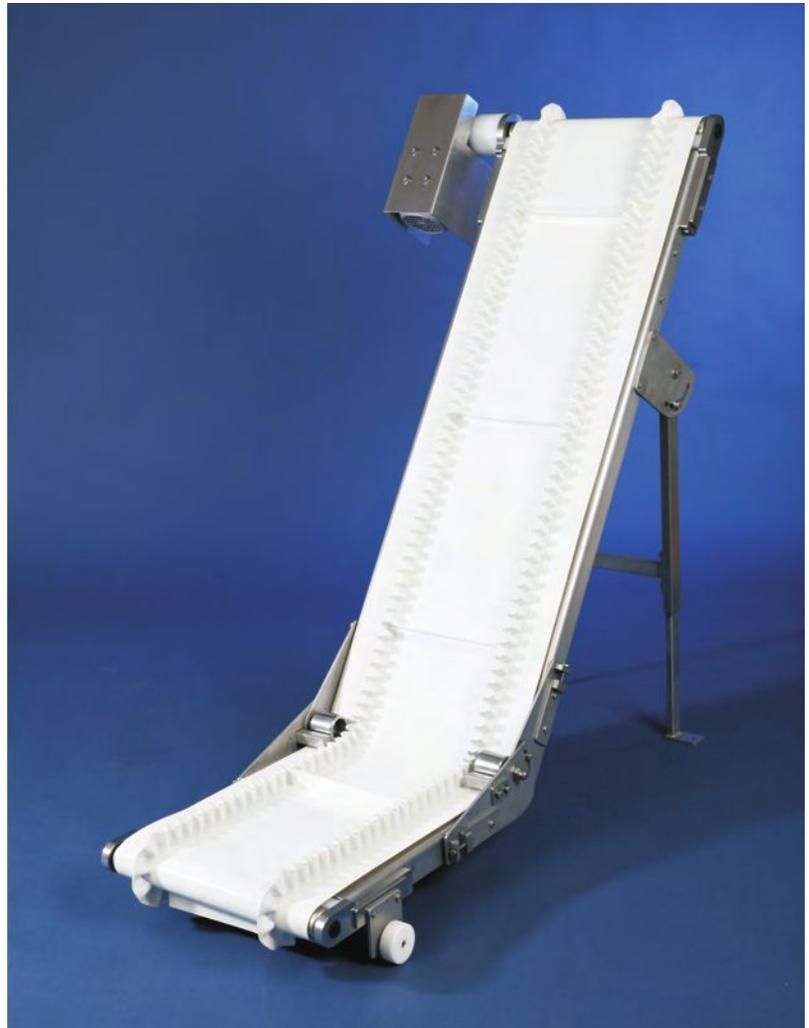
Der Anstiegswinkel des GES-50-K-W ist vom Boden aus zwischen 40 und 60° stufenlos einstellbar. Die Länge des waagerechten und des steigenden Teiles kann an den jeweiligen Einsatzfall angepasst werden. Insgesamt soll eine Länge von 4 Metern jedoch nicht überschritten werden.
