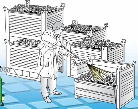
Распыление противокислителя, масла, дизельного топлива на механические детали
