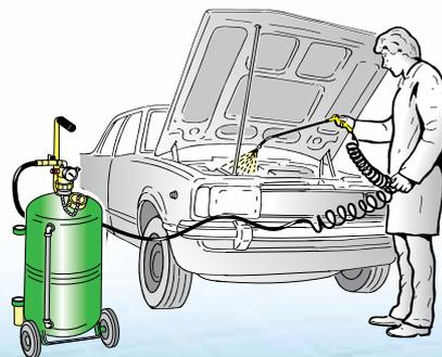
Распыление мощного средства для промывки двигателей с приблизительным расходом сопла 1 - 1,5 л/мин.
