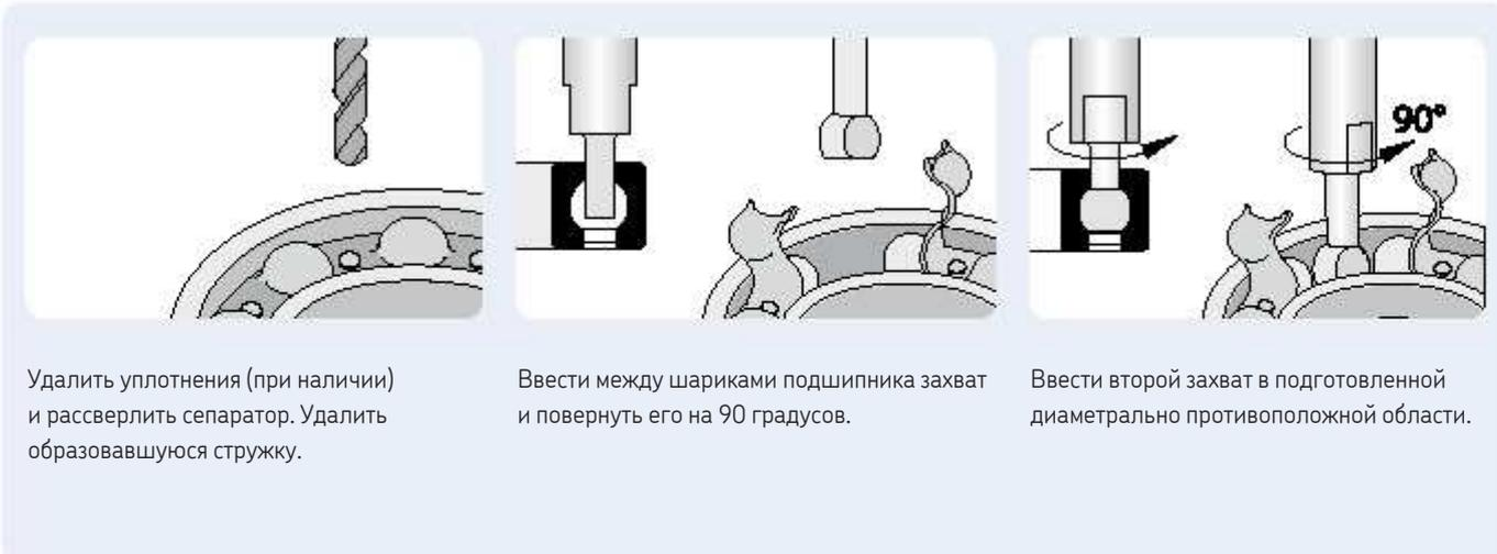
Удалить уплотнения (при наличии) и рассверлить сепаратор. Удалить образовавшуюся стружку.
