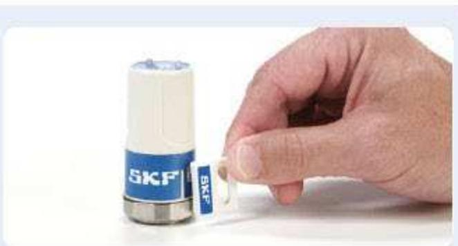
На верхней панели устройства расположены три индикатора для отображения состояния оборудования и подшипников. Кроме того, имеется штрих-код с серийным номером для идентификации оборудования в рамках программы «Обеспечение надёжности оператором» (ODR), графика техобслуживания или плановых проверок. Основание из нержавеющей стали в нижней части устройства оснащено резьбой  $\frac{1}{4}$ –28 для монтажа на штифтах.
