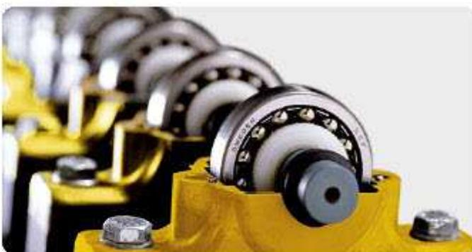
Машина Етсог для испытания пластичной смазки
