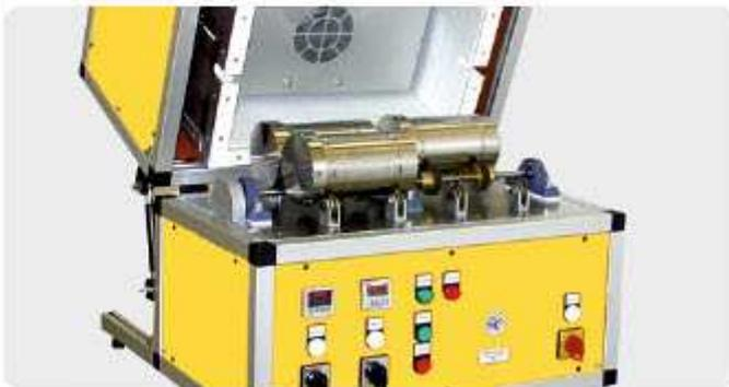
Машина для испытания стабильности при перекачивании
