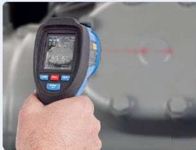
При использовании бесконтактного режима измерений термометр воспринимает тепловую энергию, излучаемую объектом, с помощью инфракрасного детектора. При наведении на объект инфракрасный датчик собирает энергию, производя сигнал, который микропроцессор преобразует в результат измерения, отображаемый на дисплее с подсветкой.
