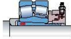
Гидравлическая гайка серии НМV ..Е используется для монтажа подшипника на закрепительную втулку.
