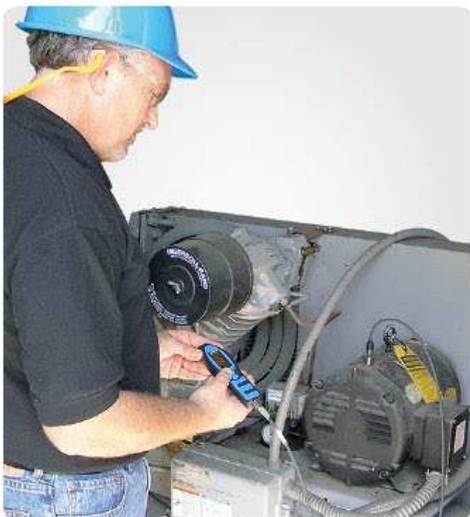
са, несоосностью и ослаблением крепления деталей, с запрограммированными в нём нормативными значениями, установленными Международной организацией по стандартизации (ISO). Если результаты измерений превышают эти нормативные значения, прибор выдаёт сигналы «Предупреждение» или «Опасность». Одновременно осуществляется измерение «огibaющей виброускорения».
