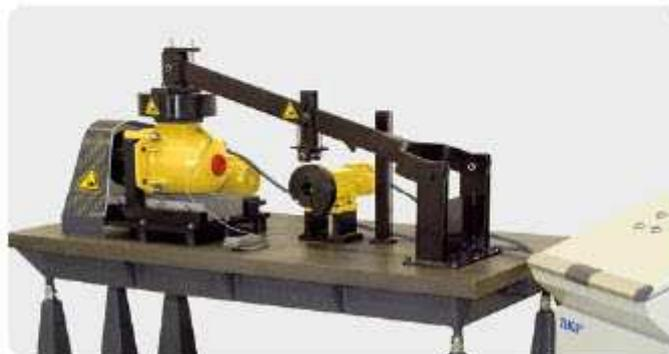
Машина V2F для испытания пластичной смазки
