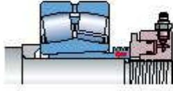
Гидравлическая гайка серии НМV ..Е используется для монтажа подшипника на стяжную втулку.
