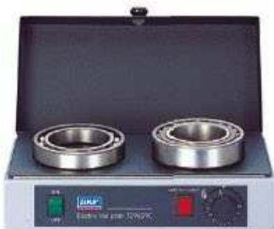
Температура нагрева подшипника регулируется термостатом
