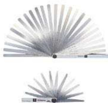
Для точного измерения зазоров в подшипниках
