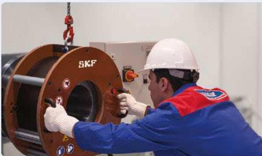
Нагреватели серии EAZ фиксированного размера представляют собой изготавливаемые под заказ индукционные нагреватели SKF для демонтажа внутренних колец цилиндрических роликоподшипников. Для выбора нагревателя серии EAZ для вашего оборудования свяжитесь с технической службой SKF. Нагреватели серии EAZ поставляются без шкафа управления. Для работы нагревателей серии EAZ фиксированного размера требуются шкафы управления SKF, которые заказываются отдельно.
