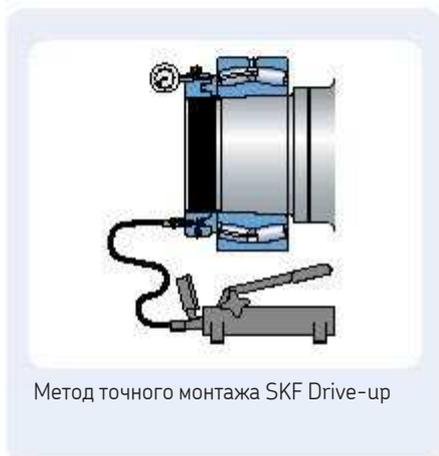
Метод точного монтажа SKF Drive-up
