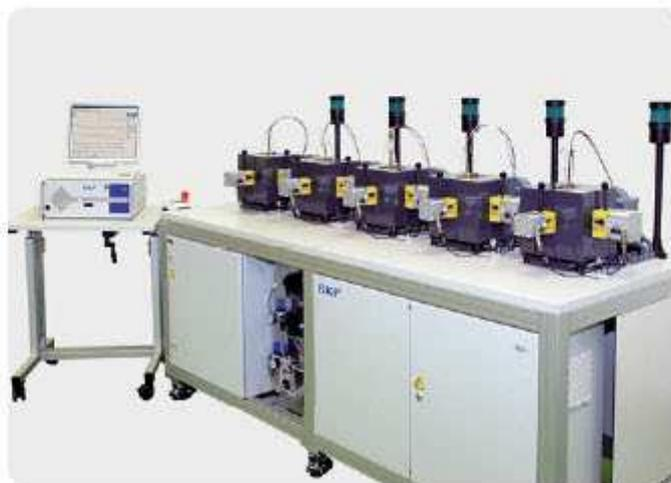
Машина ROF+ для испытания пластичной смазки
