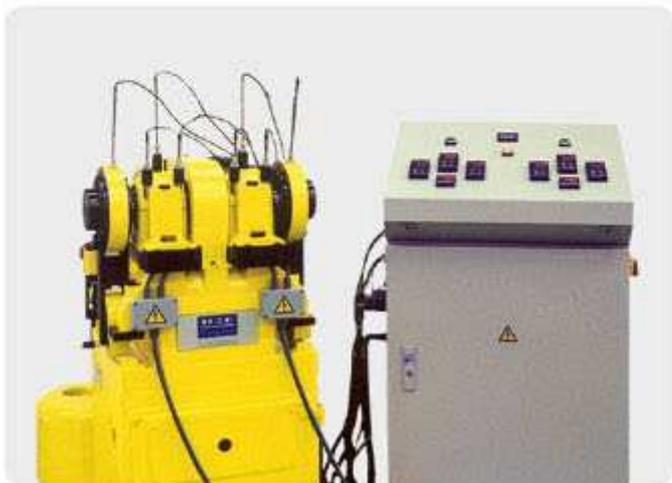
Машина R2F для испытания пластичной смазки
