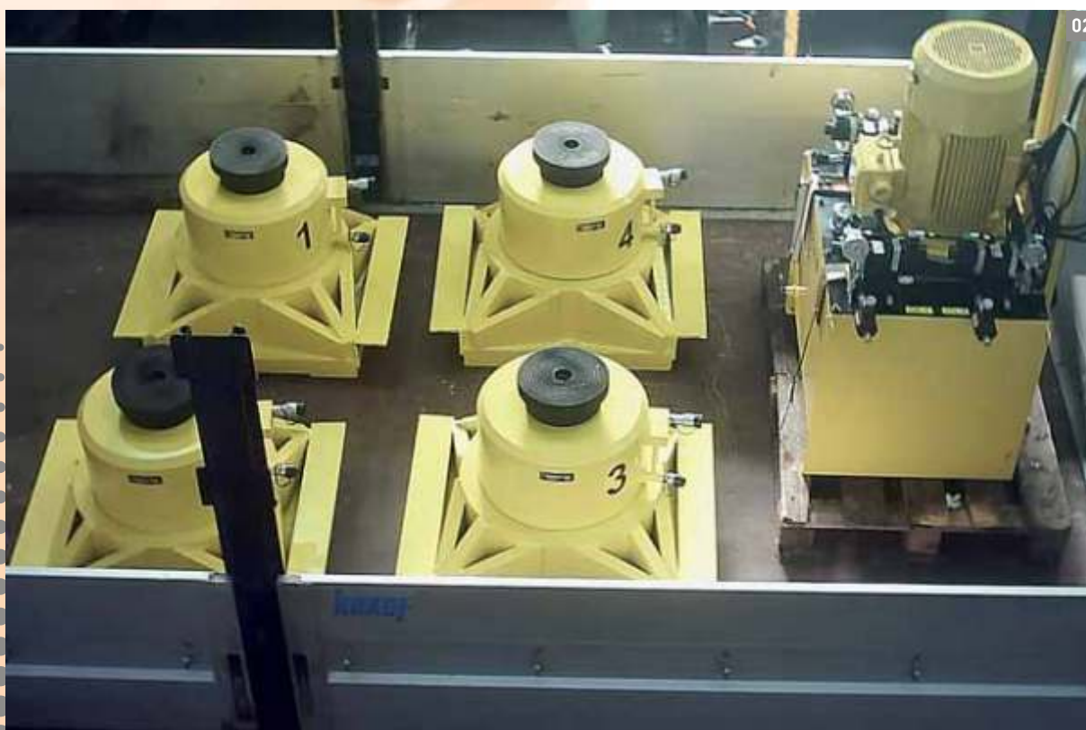
02 500-тонные цилиндры с гидравлической системой питания.
