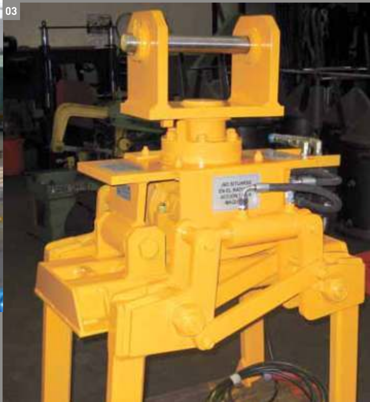
02 Специальный подъемник для лопастей ветрогенераторамассой 3,5 тонны.
