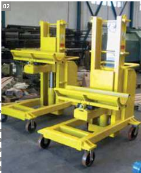
02 Специальный подъемник для лопастей ветрогенераторамассой 3,5 тонны.
