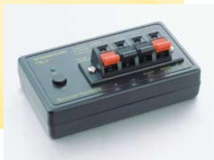
Прибор для проверки датчиков с подключением по 2, 3 или 4-х проводной схеме и выходом NAMUR.
