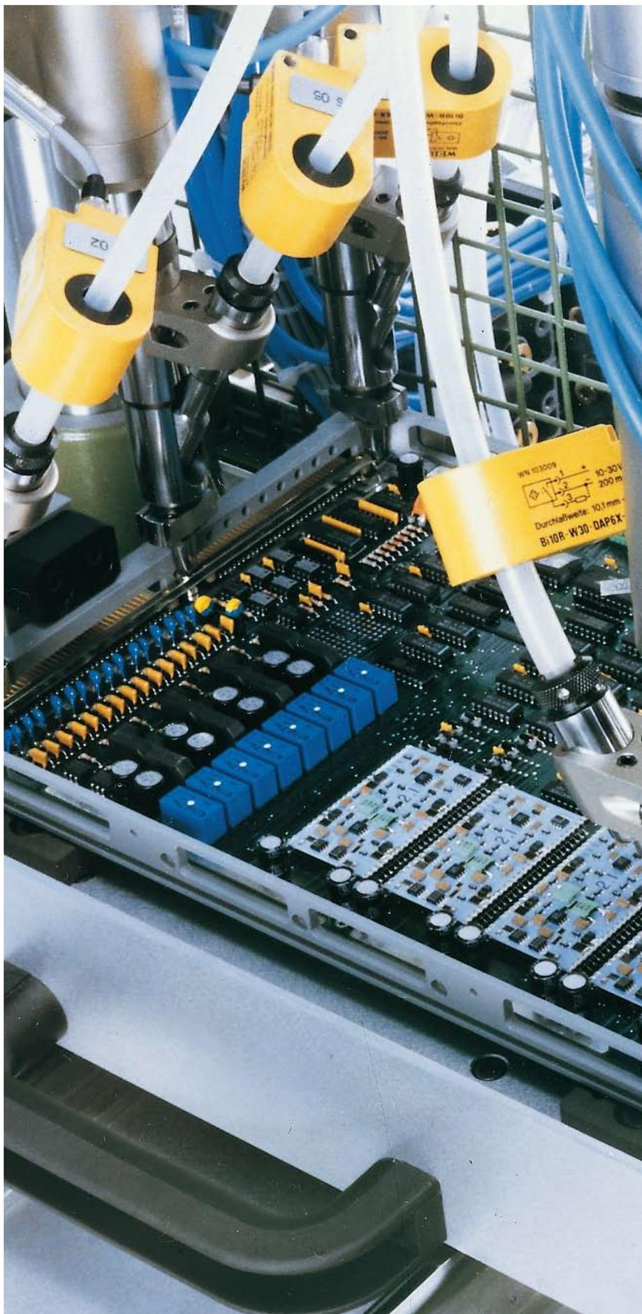
Кольцевые индуктивные датчики используются, в основном, в линиях подачи компонентов и сборочных технологических линиях для контроля подачи мелких деталей. В заворачивающих автоматах необходимо контролировать наличие в рабочей зоне только одного винта. Если винт не загружен, то это может привести к поломке или неправильной сборке. При одновременной загрузке двух винтов, может быть повреждена головка винта.
