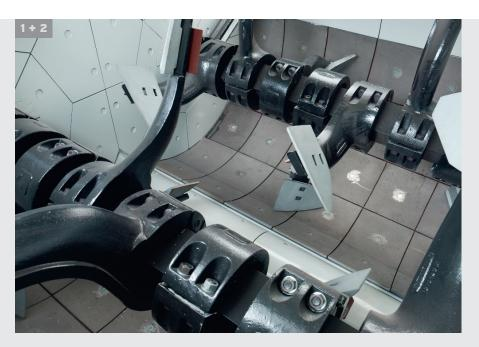
**1** | Der Mischtrog ist in Standardausführung mit hochwertigen Schleiβkacheln aus Hartguss ausgekleidet. Die Seiten- und Stirnwände sind mit austauschbaren Schleiβbelägen versehen.
