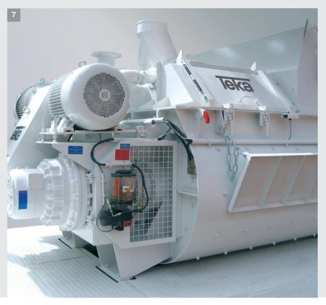
In der Schutzhaube sind beidseitig groß dimensionierte Öffnungsklappen für Wartungs- und Reinigungsarbeiten eingebaut.
