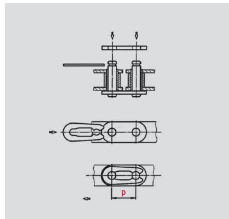
**MSS = Steckglied mit Sicherungsscheibe**
