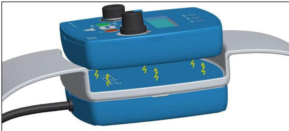
Das haften zwischen Tastatur und BLOCK erfolgt durch Magneten
