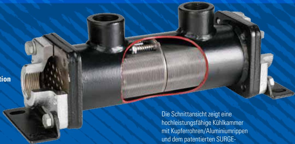
Die Schnittdarstellung zeigt eine hochleistungsfähige Kühlkammer mit Kupferrohren/Aluminiumrippen und dem patentierten SURGE-CUSHION®-Überströmungsventil.
