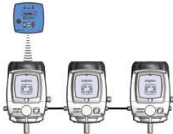
Die Slaves können auch ohne Tastatur funktionieren, sobald sie über RS485-Anschluss parametrieren werden (Hinweis: Während der Parametrierung mit der Brücke 1-6 auf J3 müssen sie jeweils allein eingeschaltet werden).
