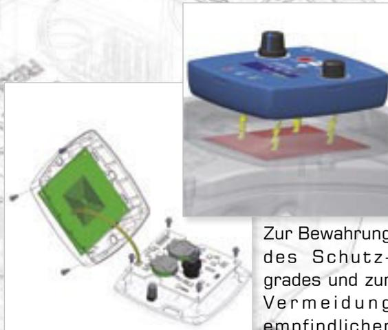
Zur Bewahrung des Schutzgrades und zur Vermeidung empfindlicher und komplizierter Anschlüsse erfolgt die Versorgung der Tastatur automatisch über Induktion, sobald das Bedienfeld auf den Deckel von NEO aufgesetzt wird. Befindet die Vorrichtung sich hingegen auf Distanz und im Remote-modus, wird sie über die wieder aufladbaren Batterien versorgt, mit denen sie serienmäßig ausgestattet ist.
